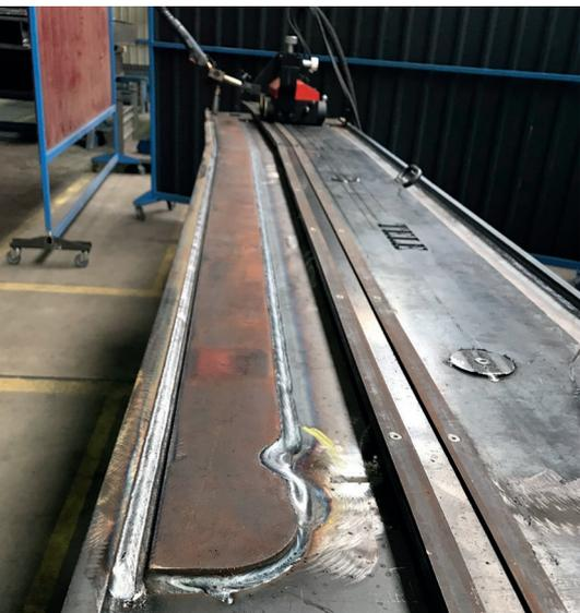
Der Schweißstraktor ist durch eine einfache Vorrichtung schnell zu installieren und erzeugt nach-arbeitsfreie gleichmäßige Nähte.
